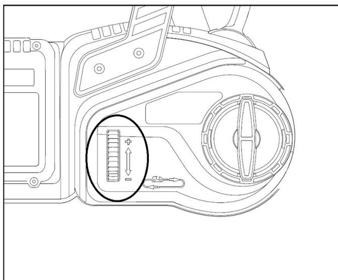
Рис. 5. Натяжение цепи болтом натяжителя
