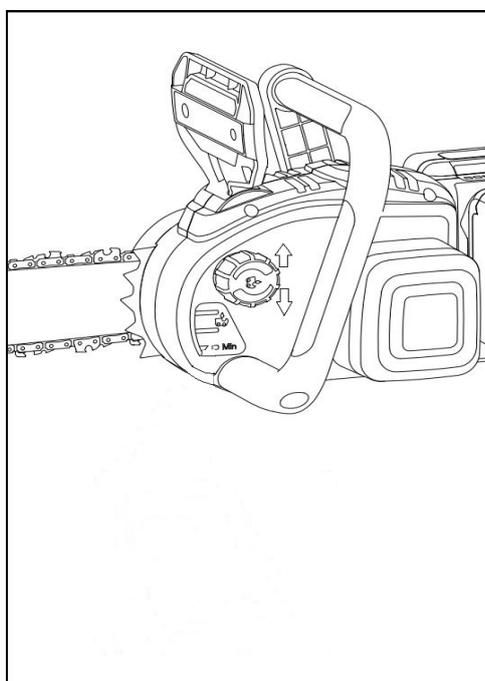
Рис. 7. Откручивание крышки маслоналивной горловины
