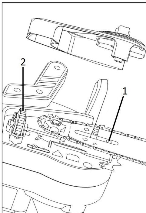
Рис. 2. Установка шины
