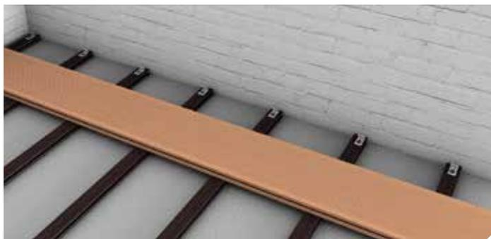
Декинг ДПК фиксируется с помощью шурупа из нержавеющей стали и пластиковой или стальной клипсы. Опорную лагу предварительно необходимо просверлить перед фиксацией клипсы. Для более плотной и равномерной фиксации доски исполь-
