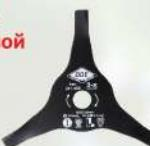
Трех-лопастной диск DDE Air Cut. Предназначен для многократного измельчения скошенной травы. За счет загнутых лопастей диск создает воздушный поток который поднимает скошенную траву и она снова попадает на режущую плоскость диска. Выбор данного диска актуален для тех пользователей которые не убирают траву после кошения. Исключительная стойкость к ударам и жесткость, благодаря толщине 3 мм, диск не замечает препятствий в виде зарослей малины, и молодого кустарника.
