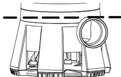
Важным фактором является уровень воды, при котором насос начинает работу. В любом случае уровень воды должен быть покрывать водозаборную часть и быть выше, чем место крепления к корпусу выходного патрубка, как показано на рисунке.
