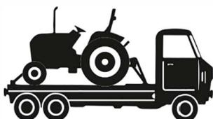
Мини-трактор лучше всего перевозить на эвакуаторе. А чтобы закрепить его на транспортном средстве, используйте цепи. Никогда не буксируйте минитрактор со скоростью, которая превышает 16км/ч. Оператор должен управлять и тормозить мини-трактором в соответствии с буксировкой — повторять траекторию буксира.
