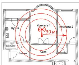
Радиус действия до **30 метров**, возможно управление устройствами в соседних помещениях (сигнал проходит через препятствия).
