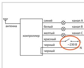
В схему питания контроллера обязательно необходимо устанавливать настенный выключатель (во избежании несанкционированного подключения первого канала при пропадании и последующем восстановлении питающего напряжения сети).
