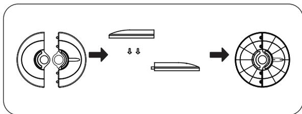
Соедините две половинки основания, вставив штырьки в соответствующие отверстия.
