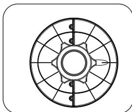
Закрепите основание вентилятора при помощи гайки.
