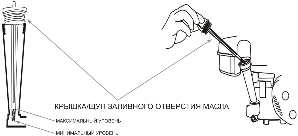
Рис. 10 Уровень масла в картере двигателя
