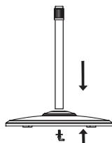
1. Выкрутите винт из стойки (Рис.2)
