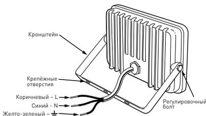
Жилы провода, подключенного к прожектору, необходимо подключить к соответствующим жилам сетевого провода. Цвета жил: коричневый – фаза 220В (L); синий - нейтраль 220В (N); желто-зеленый – защитное заземление (PE).
